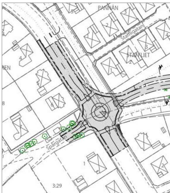
Figur 38. En cirkulationsplats anläggs i korsningen mellan Havsbadsvägen och Reningsverksvägen. Anslutande vägar ges en justerad utformning. Bullerskyddsskärmar kommer att uppföras väster om cirkulationsplatsen, på båda sidor av Spårgatan.
